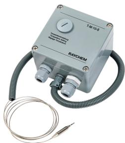
Le modèle nVent RAYCHEM T-M-10-S/+x+y est un thermostat de régulation de surface mécanique pour zone dangereuse offrant une régulation de la température pour les câbles chauffants. Disponible dans les plages de températures suivantes: 0-°C à 50-°C; 0-°C à 200-°C; 50-°C à 300-°C. Un bouchon amovible placé dans le couvercle permet de régler la température de consigne sans ouvrir le boîtier. Vous pouvez connecter directement le câble chauffant, le courant de coupure s'élève à 16-A.
